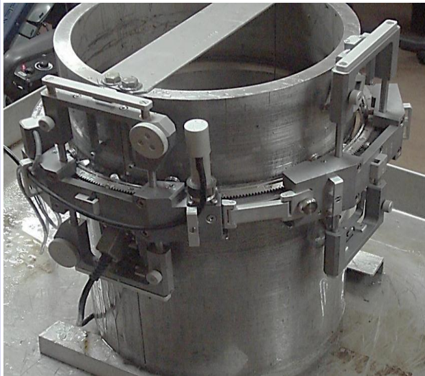
Устройство сканирования Ду300 на линейных антенных решётках трансдюсеров, "Научно - производственный центр неразрушающего контроля "ЭХО+ "
