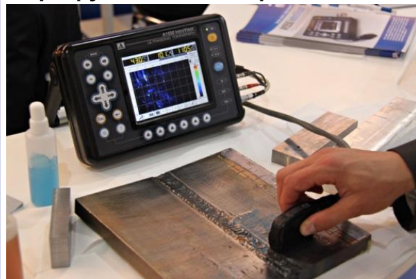
Устройство сканирования Ду300 на линейных антенных решётках трансдюсеров, "Научно - производственный центр неразрушающего контроля "ЭХО+ "
