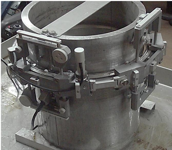
Устройство сканирования Ду300, "Научно - производственный центр неразрушающего контроля "ЭХО+"
