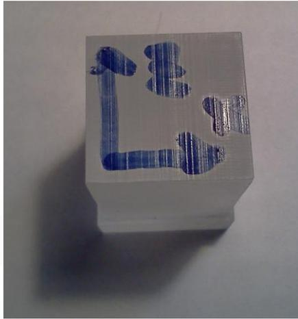
Рис. Вид заготовки из рексолита без отверстия
