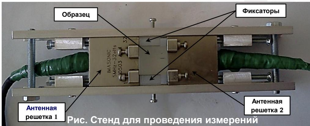
Рис. Стенд для проведения измерений
