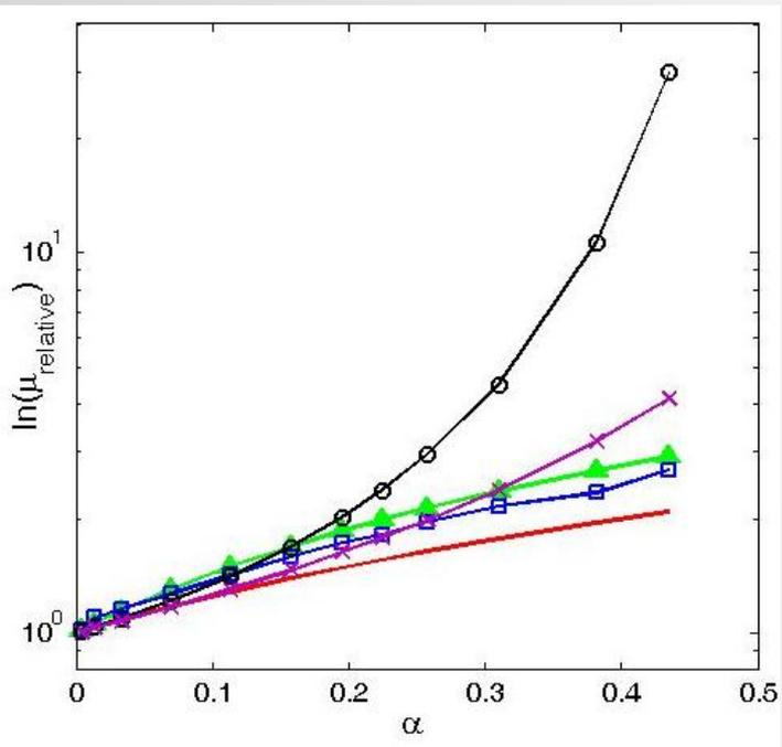
Расчет относительной вязкости для монодисперсной системы из сферических недеформируемых частиц при различных объемных содержаниях
