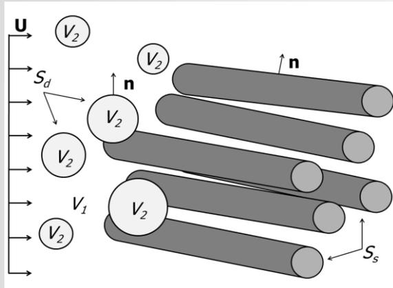
Рассматривается течение вязкой жидкости и динамика деформируемых капель одной вязкой жидкости в объеме другой вязкой жидкости при малых числах Рейнольдса в неограниченной области
