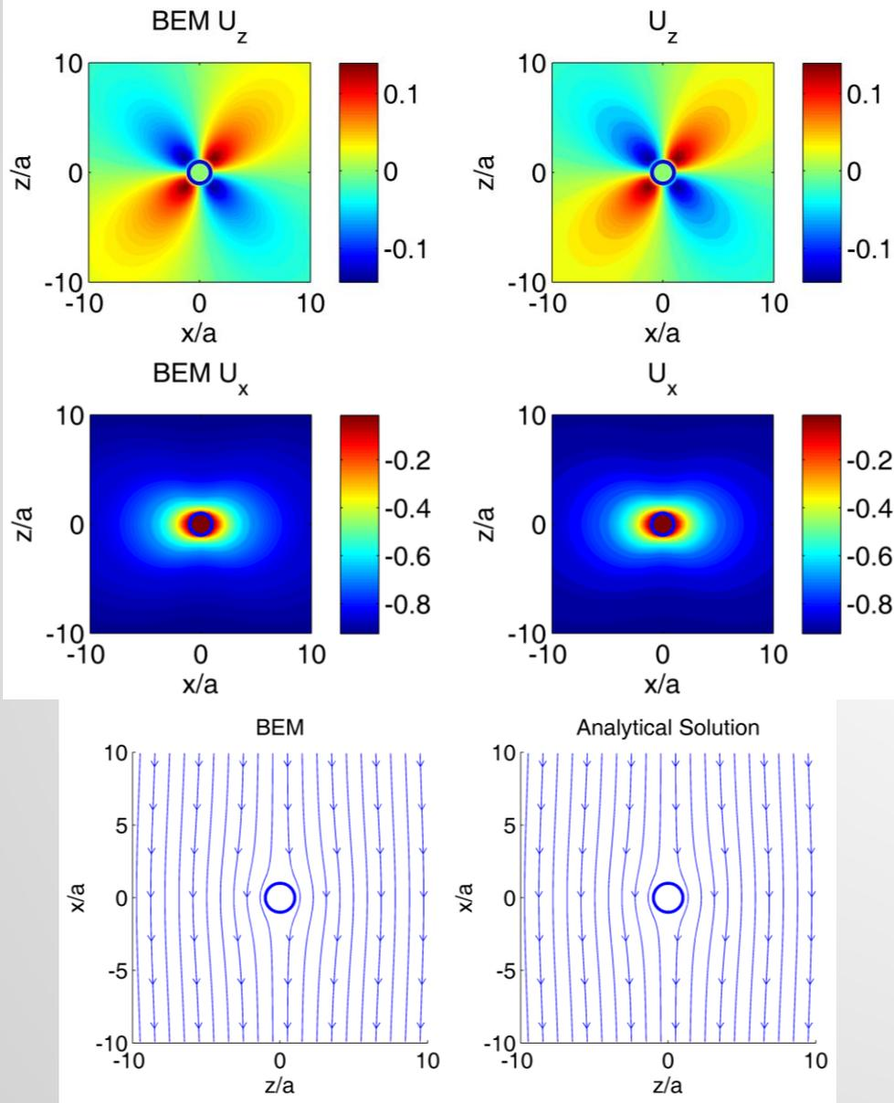
Сравнение с аналитическим решением для обтекания неподвижной твердой сферы
