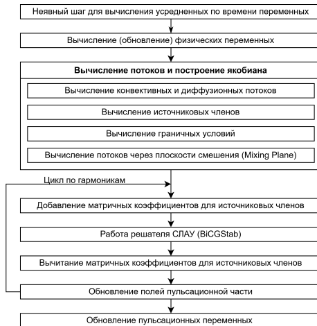
Рис. 3: Схема одного шага неявного интегрирования по времени
