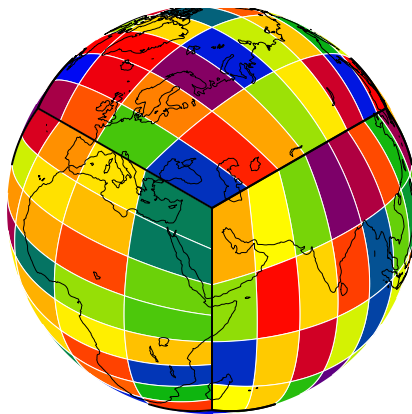
Рис. 2: Разбиение сетки кубическая сфера на 192 подобласти
