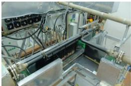
Перемешивание разнотемпературных потоков натрия за перегородкой в канале
