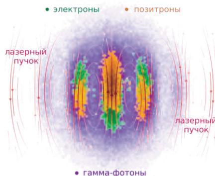
**Рис. 1.** Лавинообразное рождение электрон-позитронных пар и гамма-фотонов в результате развития КЭД-каскада в сверхсильном лазерном поле. Электрическое поле лазерного излучения представлено в форме силовых линий.
