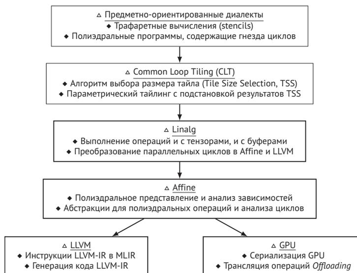
Рис. 1. Схема взаимодействия CLT с некоторыми диалектами инфраструктуры MLIR
