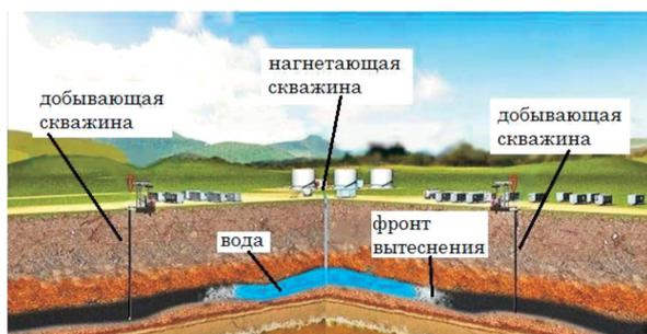
Рис. 1. Технология нефтедобычи: вытеснение нефти водой.
