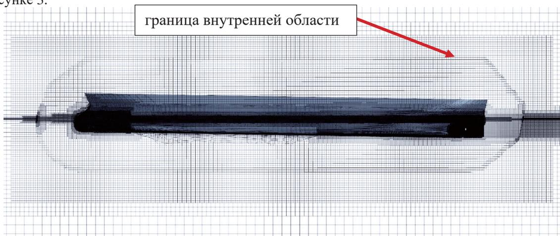
Рис. 3. Фрагмент расчетной сетки вокруг судна (пр. 1594)
