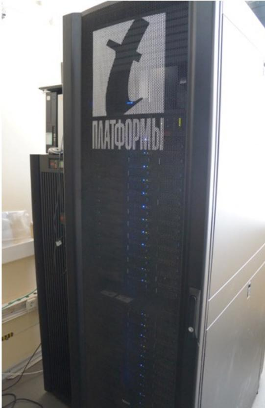
Суперкомпьютер Т-Платформы TEdge-48 компании Т-Платформы был поставлен в ОИВТ в 2008 году и состоит из 24 вычислительных модулей.
