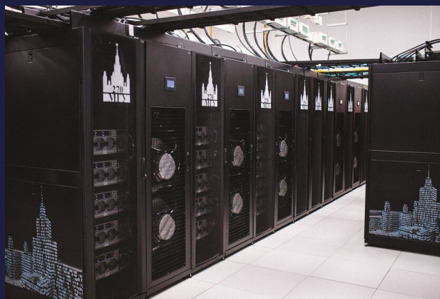
1 узел СК МГУ-270: 8 GPU, 128 CPU, 2 TB RAM
