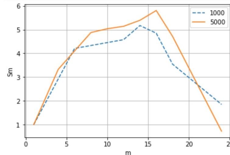
Кривые температуры для разных абсолютных проницаемостей в трещинах
