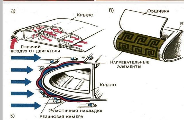
**Объектом исследования** является модельное входное устройство (МВУ) с внедренными в обшивку носка нагревательными элементами.
