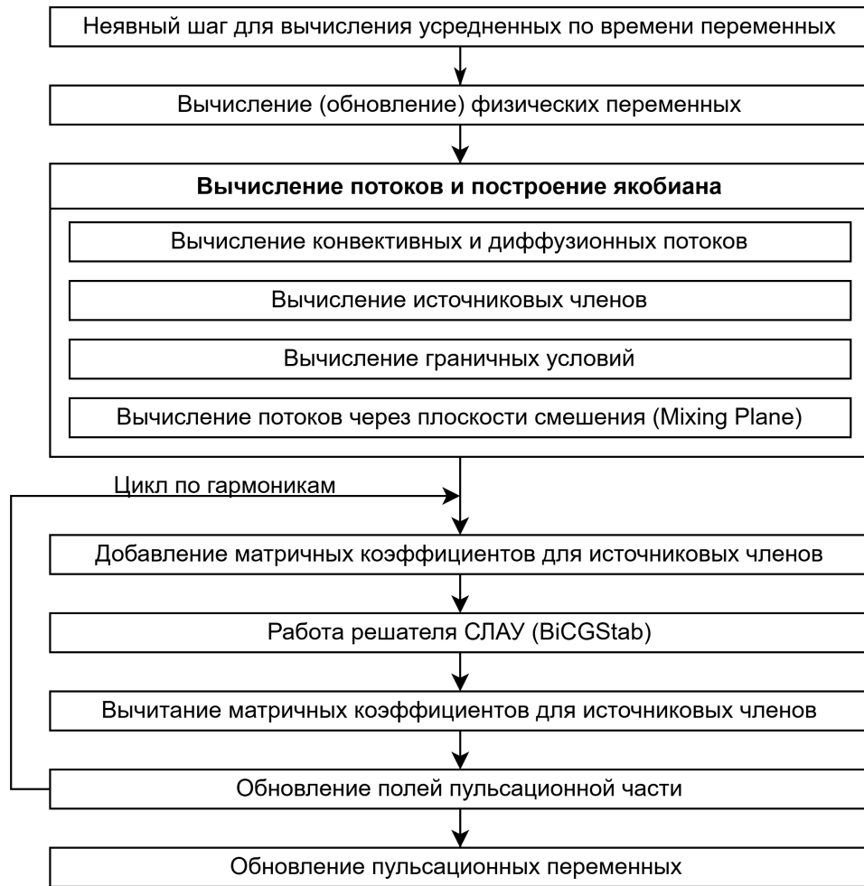
Рис. 2. Схема одного шага неявного интегрирования по времени.
